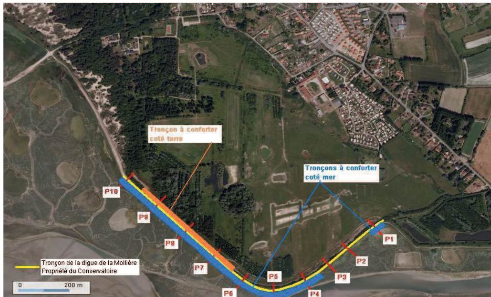
Figure 6.2 - Digue de La Mollière – Sections à conforter
